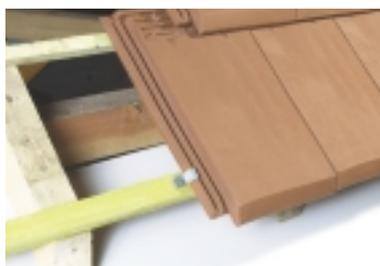
Fixation des tuiles du 1<sup>er</sup> rang d'égout par crochet "PM" Réf. CRP03.
